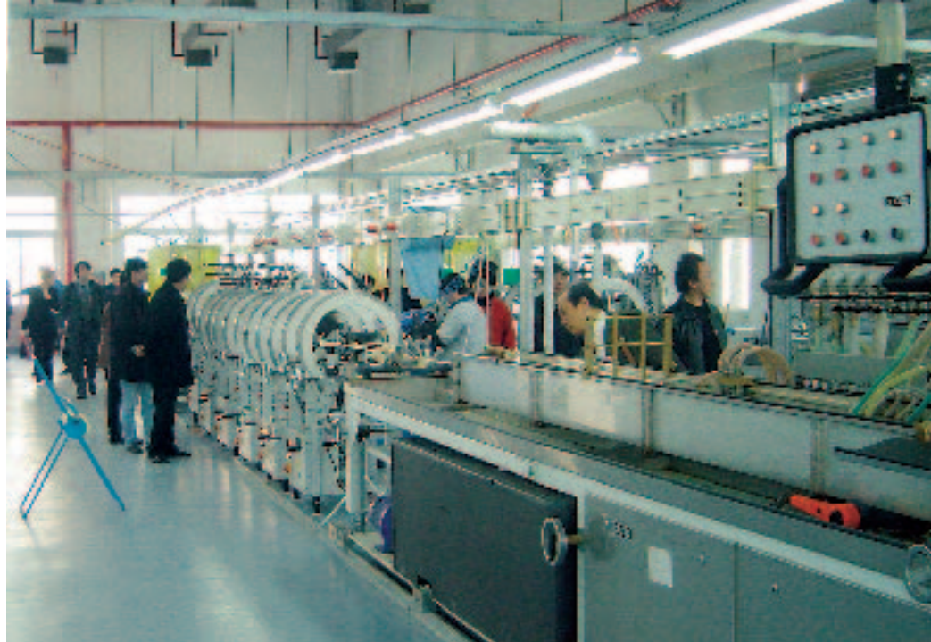
Moderner Produktionsstandort: Blick in die Produktionshallen der Shanghai Fennel Plastic Parts Co. Ltd. Mit den Anlagen, so genannten Extrudern, werden unter anderem Kunststoffprofile für die Möbel- und die Haushaltsgeräteindustrie gefertigt.
